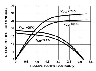
FIGURE 23. RECEIVER OUTPUT CURRENT VS RECEIVER OUTPUT VOLTAGE
