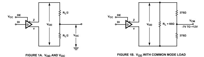
FIGURE 1. DC DRIVER TEST CIRCUITS
